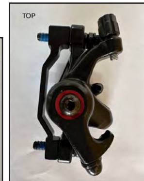
11 Remove rear adjuster and pads & spring carefully. Check for wear on disc pads. Inspect and re-new if needed. Retirer la vis de réglage arrière ainsi que le ressort - Vérifier l'usure des plaquettes et remplacer si nécessaire
