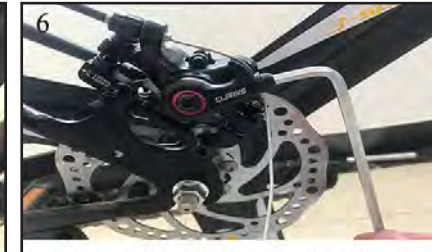
6 Tighten the pinch bolt, checking wire is positioned. Serrer le serre câble en vérifiant le bon positionnement du câble
