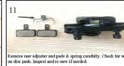
11 Remove rear adjuster and pads & spring carefully. Check for wear on disc pads. Inspect and re-new if needed. Retirer la vis de réglage arrière ainsi que le ressort - Vérifier l'usure des plaquettes et remplacer si nécessaire
