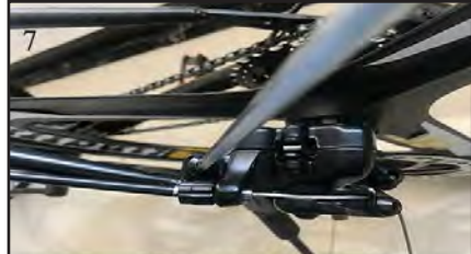
7 Apply pressure to brake lever, hold, tighten caliper bolts Maintenir le levier de frein serré et serrer les boulons de l'étrier
