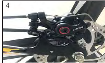
4 Carefully feed the cable wire through the adjuster Insérer le câble soigneusement dans le logement prévu
