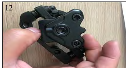
12 Replace the pad and spring assembly carefully Remplacer les plaquettes et remonter le ressort soigneusement
