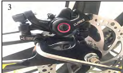
3 Tighten the bracket bolts fully, using spacers provided. Serrer les boulons fermement en utilisant les rondelles fournies
