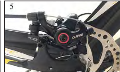
5 Insert the wire end through the pinch bolt Passer le câble dans le serre-câble
