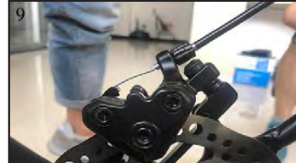
9 Remove caliper from frame, no need to disconnect wire Retirer l'étrier du cadre - inutile de retirer le câble
