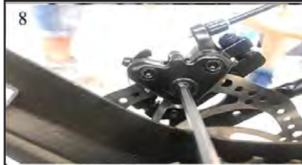
8 Adjust rear pad until slight clearance from rotor is achieved Ajuster la plaquette arrière jusqu'à arrêt du frottement du disque
