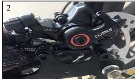
2 Insert the caliper bracket behind the frame bosses Insérer le collier de l'étrier derrière la patte de cadre
