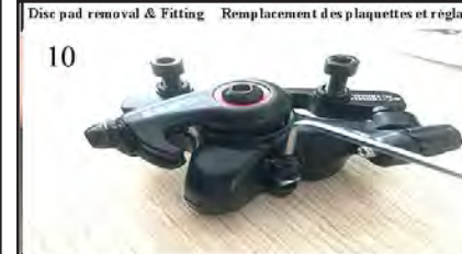
10 Remove caliper from frame, no need to disconnect wire Retirer l'étrier du cadre - inutile de retirer le câble
